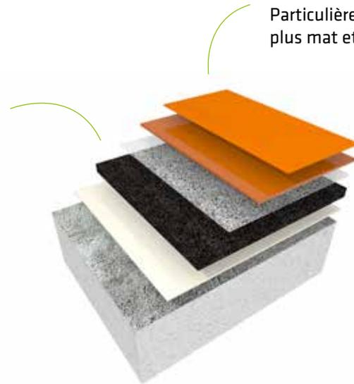
La couche supérieure multifonctionnelle de 2 mm résiste extrêmement bien à la contrainte. Particulièrement résistante à l'usure, elle est de plus mat et facile à nettoyer.
