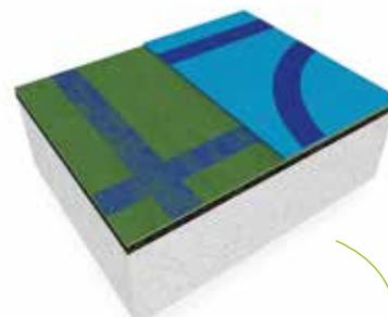
En caso de renovación, se incorporan nuevas capas sobre el pavimento actual. El pavimento deportivo quedará como nuevo.
